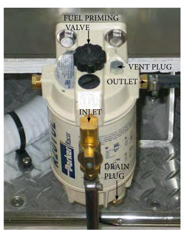
TYPICAL GENERATOR EXTERIOR FUEL FILTER
