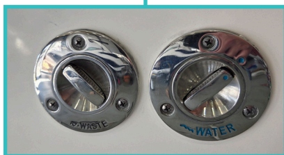
Freshwater fill inlet
