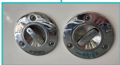
Freshwater fill inlet
